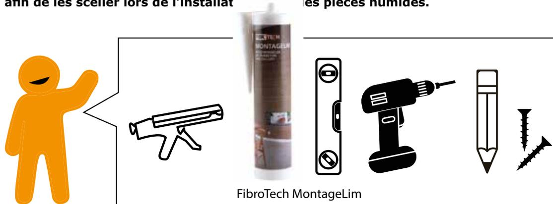
Vous aurez besoin de colle, d'un pistolet à colle, un niveau, une visseuse et des vis Fibrotech noires. Il est aussi recommandé d'utiliser des gants en coton pour le montage NB: Du fait que les panneaux contiennent du bois, ils peuvent dégager une légère odeur naturelle. C'est pourquoi nous recommandons de laisser les panneaux s'acclimater avant le montage.
