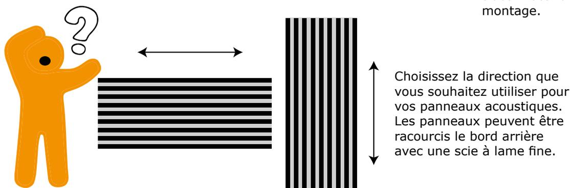
Choisissez la direction que vous souhaitez utiliser pour vos panneaux acoustiques. Les panneaux peuvent être raccourcis le bord arrière avec une scie à lame fine.
