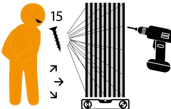
Les panneaux acoustiques sont montés au mur / plafond avec des vis. Il y a 15 vis pour chaque panneau. Pour les coffrages, la distance doit être de 60 mm.
