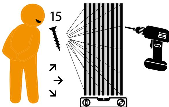
Les panneaux acoustiques sont montés au mur / plafond avec des vis. Il y a 15 vis pour chaque panneau. Pour les coffrages, la distance doit être de 600 mm.
